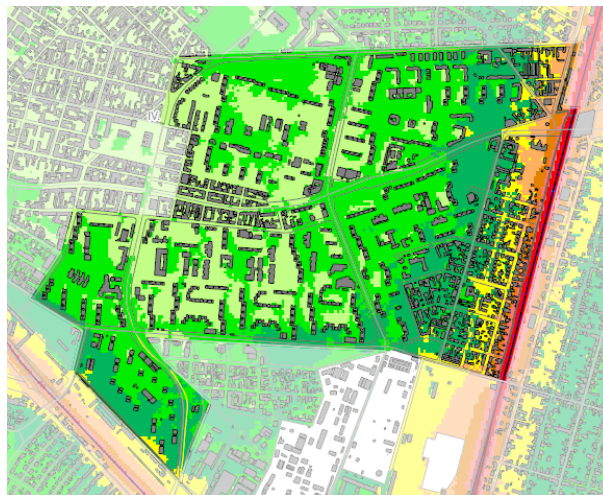
Vasúti zajterhelés éjjel
