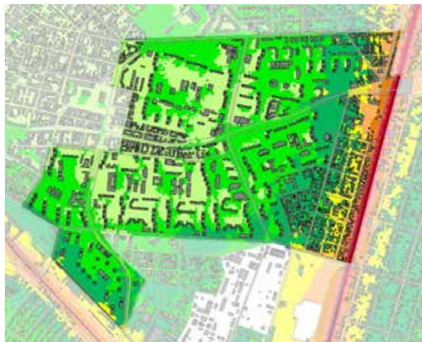
Vasúti zajterhelés éjjel
